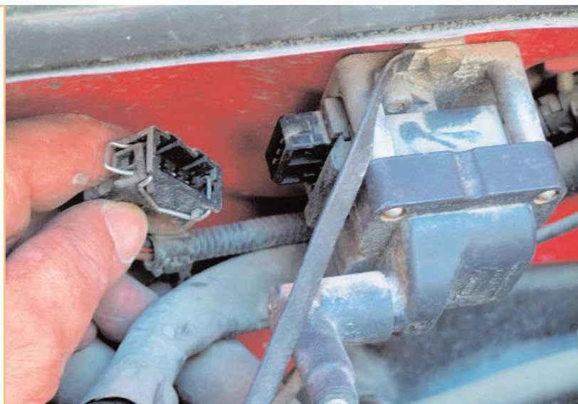
Έλεγχος ωμικής αντίστασης του πρωτεύοντος πηνίου του πολλαπλασιαστή
